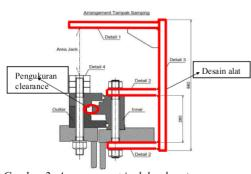
Gambar 3. *Arrangement jack load* saat pengujian dengan alat bantu.
