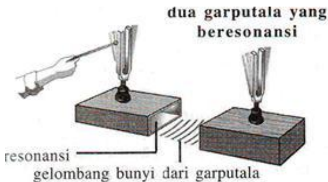
Gambar 2.15. Resonansi dengan garpu tala
