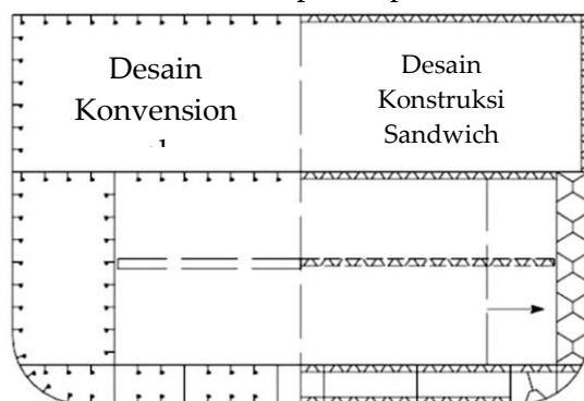
Gambar 2. Perbandingan konstruksi antara model konvensional dan konstruksi sandwich (Sumber: Palomba dkk., 2021).
