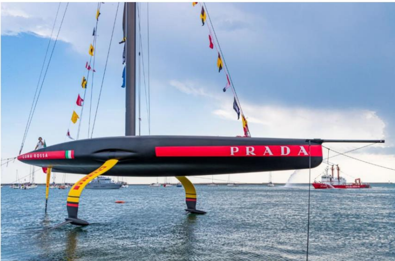
Gambar 5. AC75 Luna Rossa terbuat dari CFRP-aluminum honeycomb sandwich panels (Sumber: https://www.giornaledellavela.com ).
