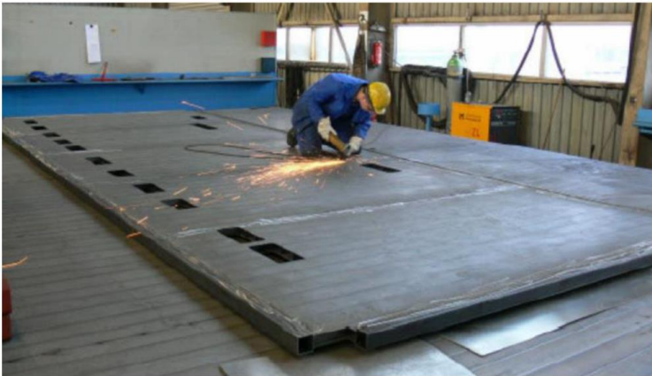
Gambar 3. Ruang sandwich board dibuat dari steel sandwich panel (Sumber: Kortenoeven dkk., 2008).
