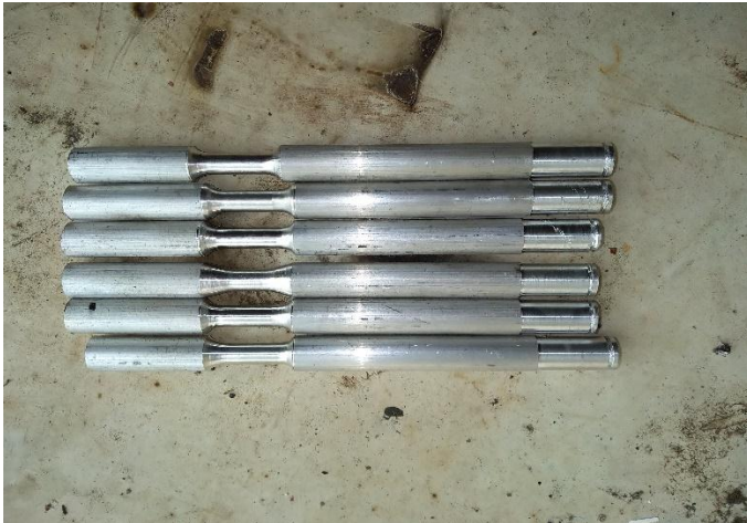
Lampiran 4 spesimen Aluminium 6061 yang sudah dibubut sesuai ASTM E446
