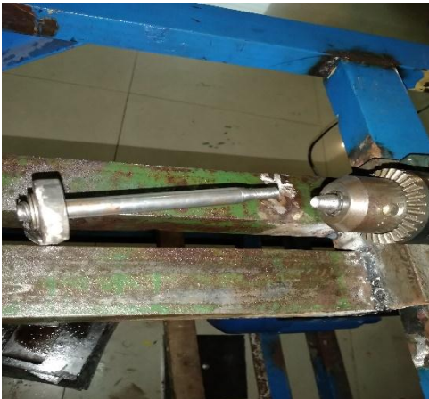
Lampiran 8 spesimen yang telah ketika di uji fatik untuk Baja ST 41
