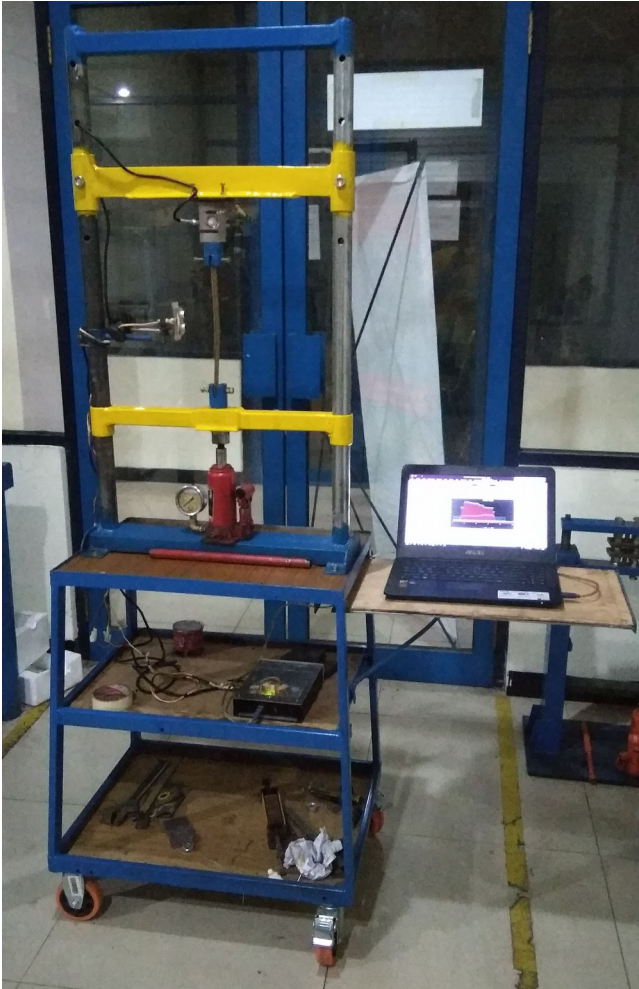
Alat jadi AUBP Berbasis Arduino Uno
