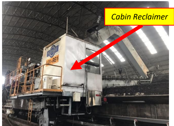
Gambar 2. 11 Cabin Kontrol Reclaimer (Sumber: Dokumen Peneliti)
