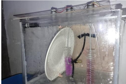
Gambar 4.2 Pengujian Pompa Air dalam Keadaan Menyala
