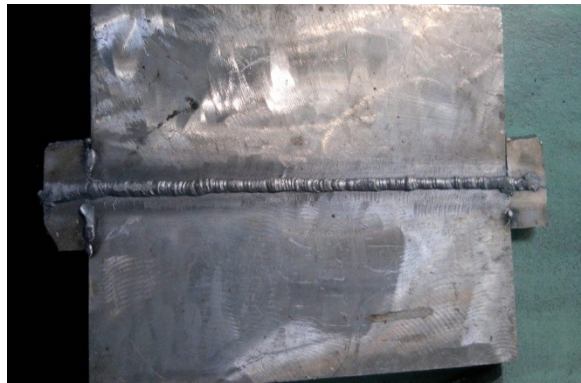
Gambar 4.4 Hasil uji visual dari pengelasan SMAW
