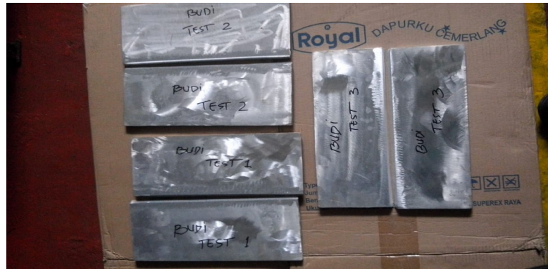
Gambar 4.2 Plat aluminium seri 5083 dengan kampuh V sebelum dilakukan pengelasan
