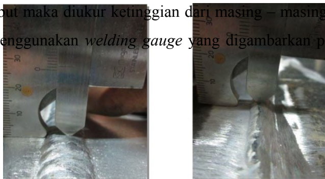
Gambar 4.4 Hasil uji visual dari pengelasan SMAW
