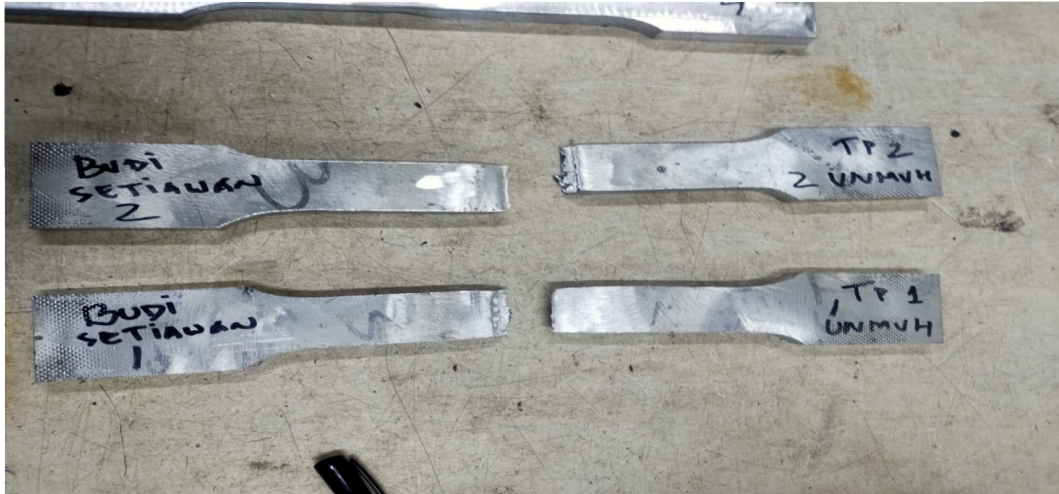
Gambar 4.15 Hasil material yang telah dilakukan uji tarik.
