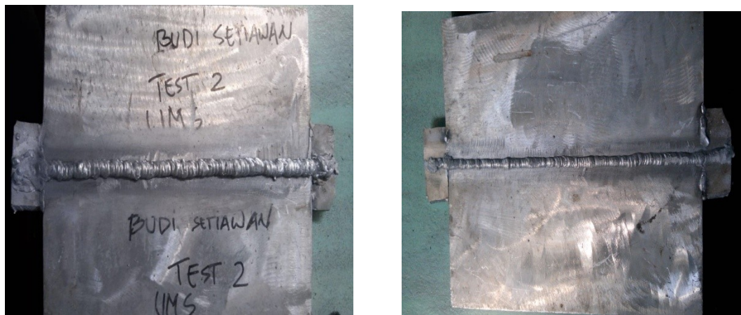
Gambar 4.3 Hasil pengelasan plat aluminium seri 5083 dengan menggunakan metode SMAW
