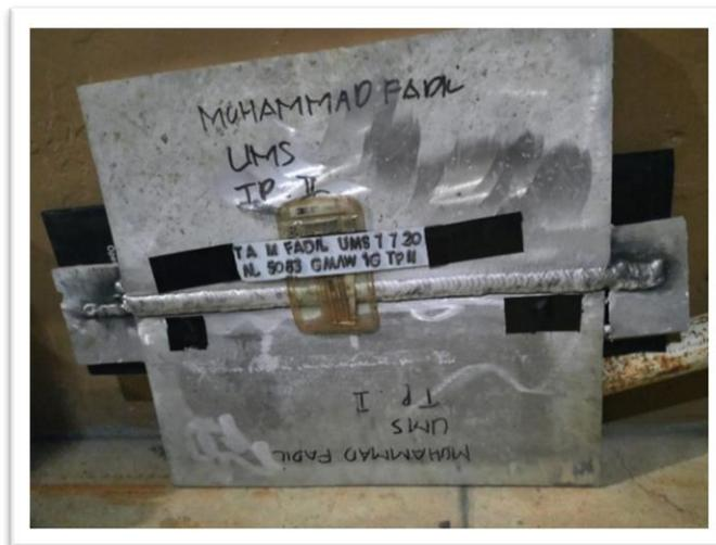
Gambar 3.21. Pemasangan film pada spesimen uji
