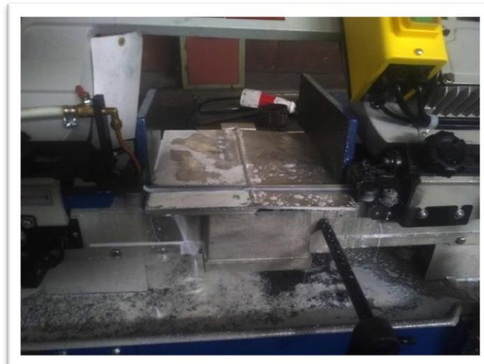
Gambar 3.16. Proses pemotongan ujung spesimen dengan mesin gergaji
