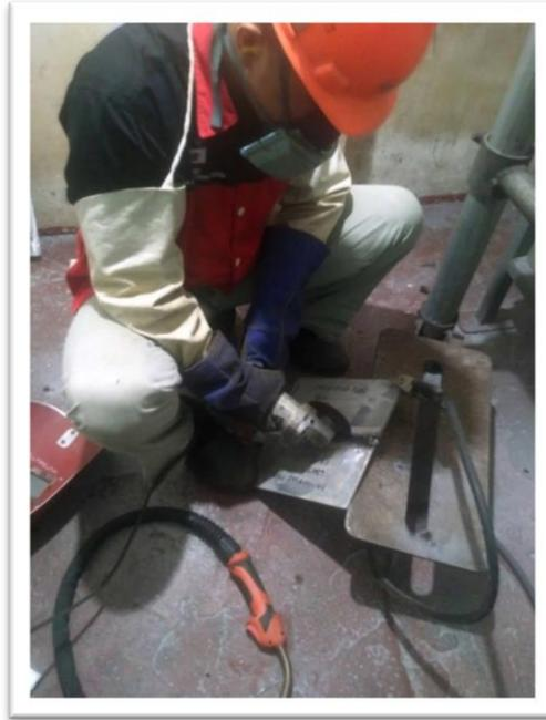
Gambar 3.14. Proses pembersihan *spatter*
