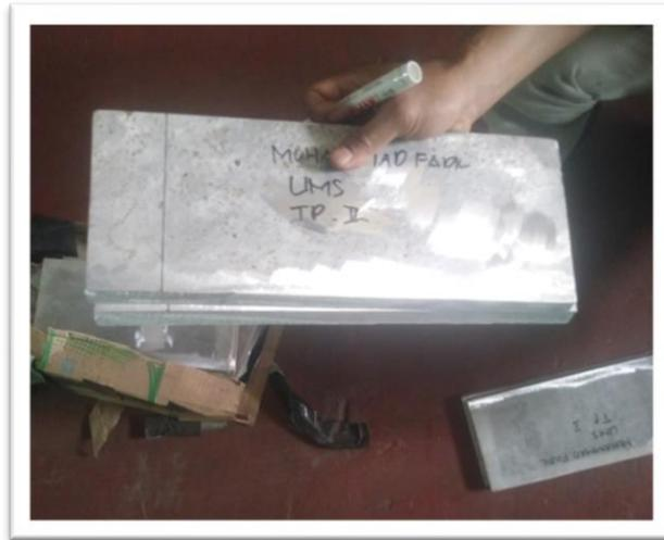
Gambar 3.8. Material yang telah di *bevel* dan dirapikan dengan dihaluskan
