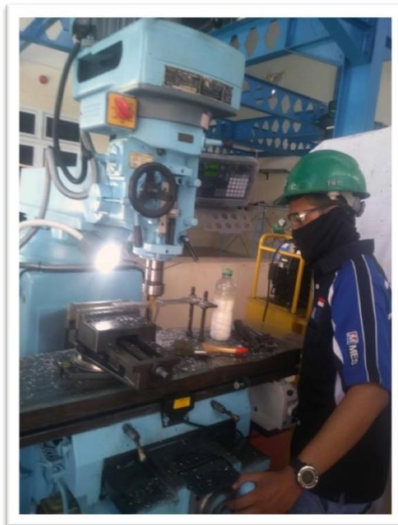
Gambar 3.18. Proses pembuatan *test pieces tensile strength* dengan *milling machines*
