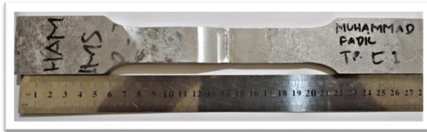
Gambar 4.14. Daerah patahan spesimen TP NC1 dengan perlakuan chamfer
