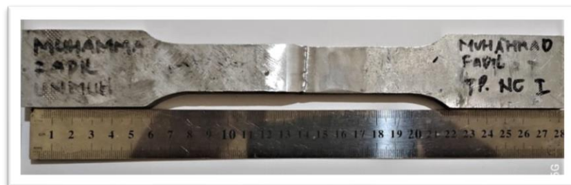
Gambar 4.12. Daerah patahan spesimen TP C1 dengan perlakuan chamfer
