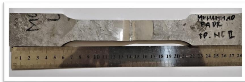
Gambar 4.11. Daerah patahan spesimen TP C2 dengan perlakuan chamfer
