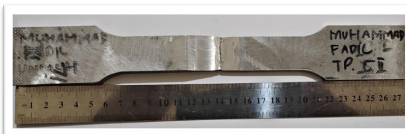
Gambar 4.13. Daerah patahan spesimen TP NC2 dengan perlakuan chamfer
