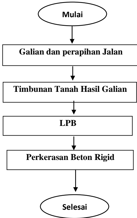
Gambar 2.2.1: Bagan Alir Pekerjaan Persiapan
