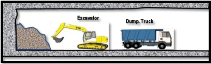
Gambar 2.2.3: Simulasi pekerjaan pembuangan tanah hasil galian terowong Sumber : Data Teknik PT Brantas Abipraya (Persero) 2018
