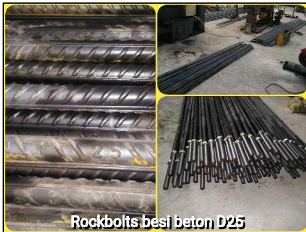
Gambar 4.10: Foto contoh material rock bolt Sumber : Data Teknik PT Brantas Abipraya (Persero) 2020
