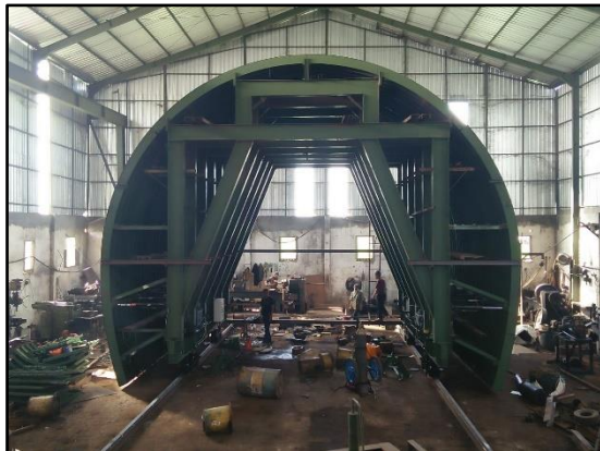
Gambar 4.17: Foto Sliding Form Sumber : Data Teknik PT Brantas Abipraya (Persero) 2020
