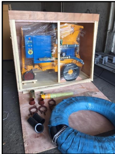
Gambar 4.7.2 : Foto alat shotcrete dan aksesorisnya Sumber : Dokumentasi pribadi
