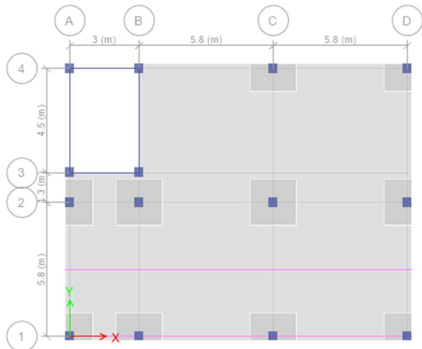
Gambar 4. 1 Denah Flat Slab Dengan Drop Panel
