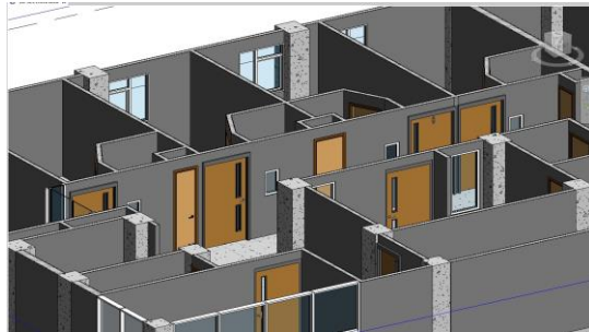
Gambar 7. 4 Permodelan jendela dan pintu dengan Revit Architecture
