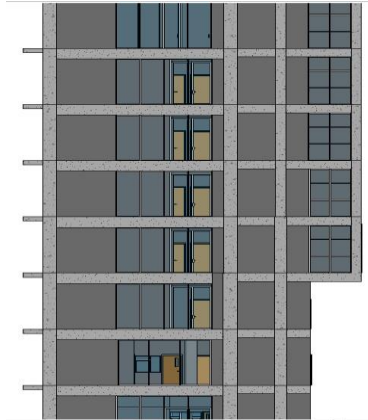
Gambar 7. 3 Permodelan dinding Curtain Wall dan Basic Wall
