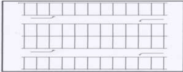
Gambar 2.7 Pola parkir pulau membentuk sudut 90^\circ
