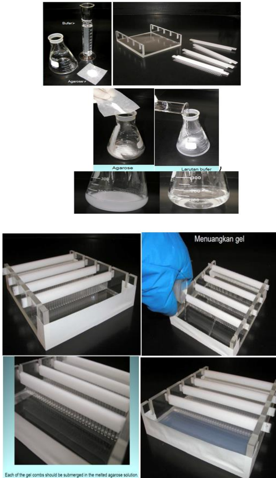
Gambar 9.5 Prosedur Pembuatan Gel Agarose
