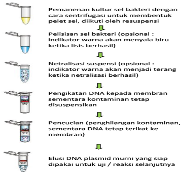
Gambar.7.7 Skema Isolasi DNA plasmid E. coli MDR Ciprofloxacin
