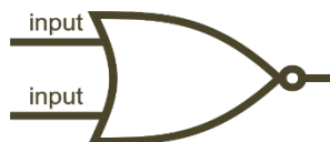
Gambar 4.13. Notasi NOR setelah di sederhanakan
