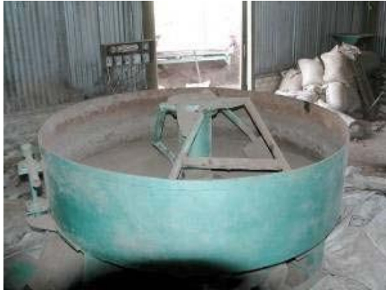
Gambar 15. Mixer untuk mencampur dan mengaduk bahan baku pupuk organik
