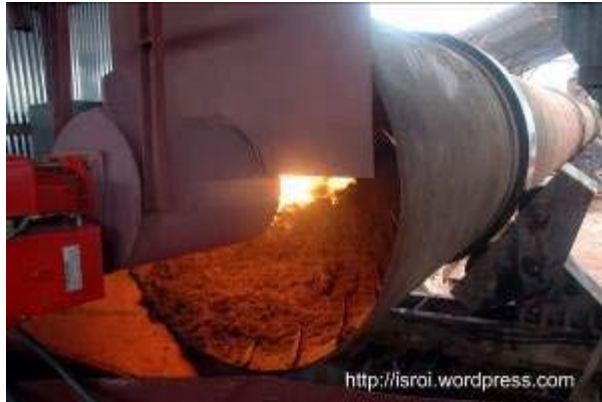
Gambar 31. Pengeringan granul dengan mesin pengering. Sumber : http://isroi.wordpress.com
