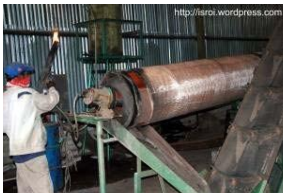
Gambar 17. Mesing pengering di pabrik pupuk organik dengan burner berbahan bakar solar.
