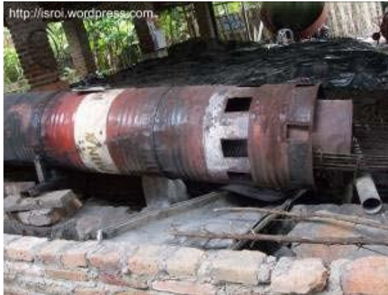
Gambar 16. Mesin pengering sederhana dengan tabung dari sambungan drum dan bahan bakar minyak tanah.
