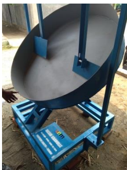
Gambar 13. Pan Granulator ukuran kecil dengan diameter pan 80cm Sumber : PKM Hibah Kemenristek-Dikti di Desa Pakis Kecamatan Trowulan, Kabupaten Mojokerto
