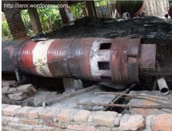
Gambar 16. Mesin pengering sederhana dengan tabung dari sambungan drum dan bahan bakar minyak tanah.
