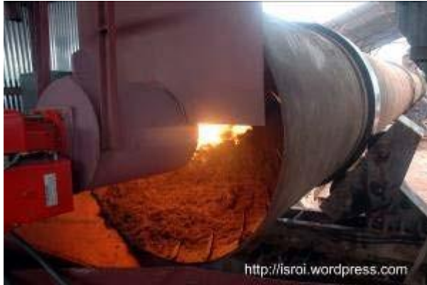
Gambar 31. Pengeringan granul dengan mesin pengering. Sumber : http://isroi.wordpress.com
