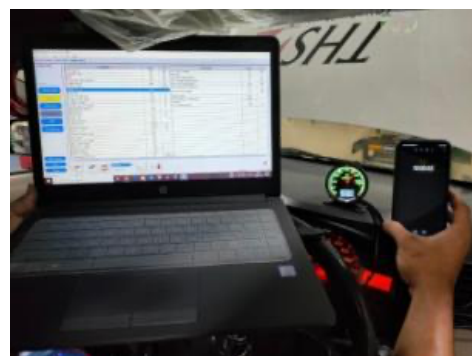
Gambar 3. Pengambilan data dengan Global tecstream , stopwatch , dan sensor termokopel
