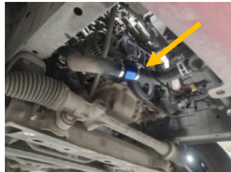
Gambar 2. Thermokopel pada selang bawah Toyota Avanza 1.3 GM/T
