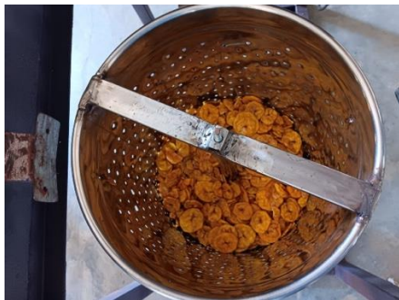
Gambar 6. Kondisi sebelum penirisan di mesin spinner
