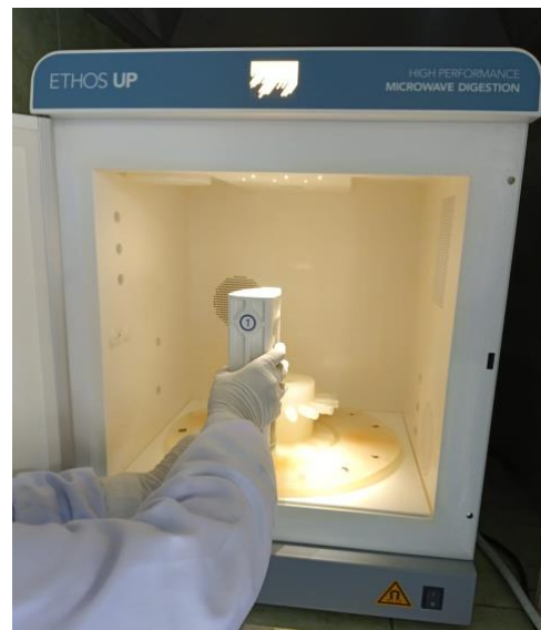
Dimasukkan Microwave Digester untuk proses destruksi
