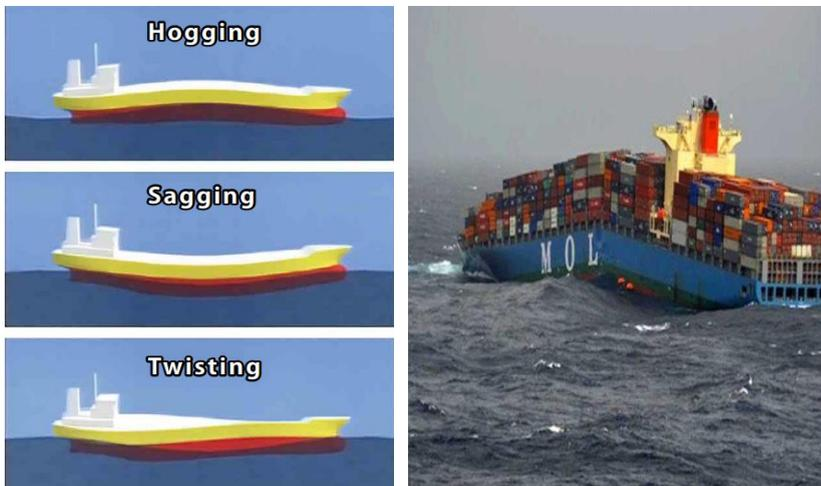
Gambar 2.3 Kondisi kapal pengaruh peletakan muatan
