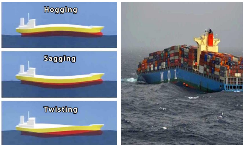
Gambar 2.3 Kondisi kapal pengaruh peletakan muatan
