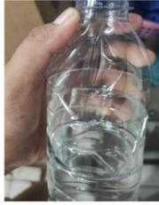
Gambar 4. *Defect* Tutup Botol Peyok
