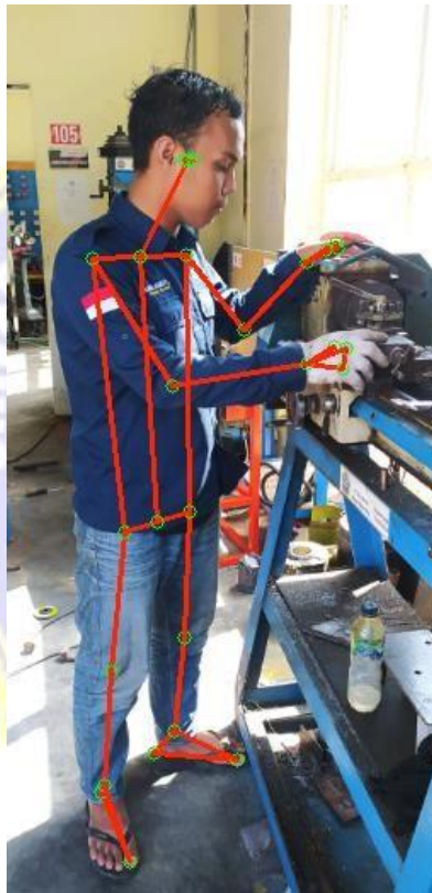
Gambar 2. 18 Postur Kerja Hasil Implementasi Aplikasi Xpose pada Praktikan Sedang Menggunakan Mesin Bubut (Titik Hijau adalah Landmark dan Garis Merah adalah Line-Connections)(Kusuma & Akbar, 2024).
