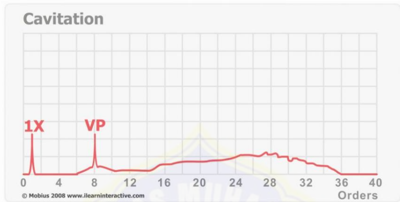
Gambar 2. 22. Spectrum dari Kavitasi Sumber : (Mobius Institute, 2015)
