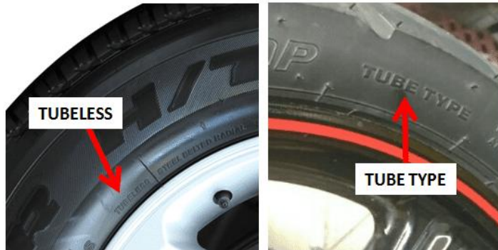
Gambar 2. 15 Perbedaan Kode Ban Tubeless dan Tube Type
