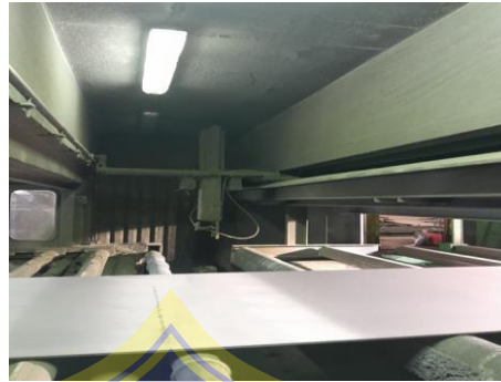
Gambar 3. 6 nozzle bergerak melintang (kanan-kiri) secara berulang, sementara plat bergerak lurus ke depan Sumber: Dokumentasi Pribadi penulis, 2025
