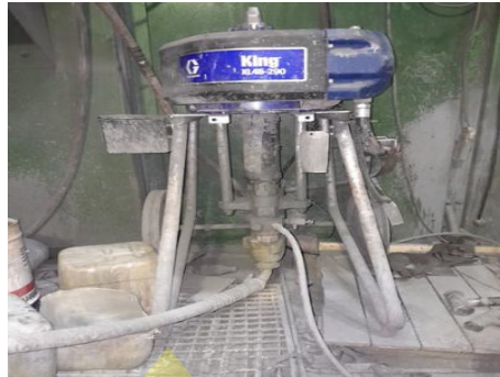
Gambar 3. 3 airless spray dinyalakan Sumber: Dokumentasi Pribadi penulis,2025
