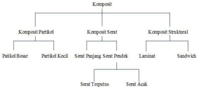
Gambar 2. 1 Struktur Umum Material Komposit
