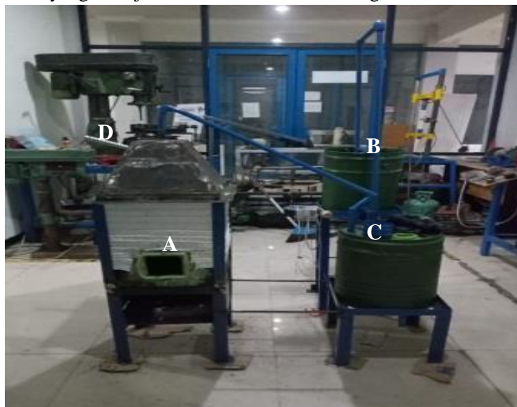
Gambar 1. Alat distilasi untuk proses pirolisis
