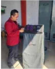
Gambar 3. Pembacaan hasil uji emisi dari pembakaran
