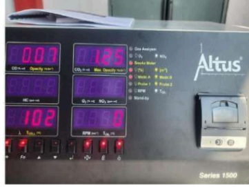
Gambar 4. Hasil pembacaan kepekatan asap dengan alat merk Altus
