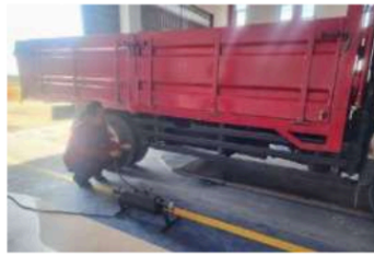
Gambar 2. Pemasangan sensor untuk mengetahui kepekatan emisi
