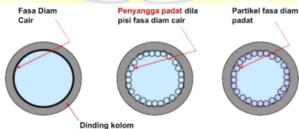
Gambar 2.14 Tiga jenis kolom kromatografi gas (GC) berdasarkan jenis fasa diam yang digunakan (Andriana, Y., 2019)
