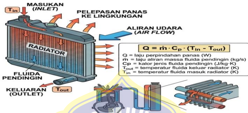
Gambar 2.8 Mekanisme Perpindahan Panas pada Radiator Sistem Pendinginan Mesin Diesel Sumber : (Haurissa and Wambaruw 2024)
