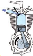
Gambar 2.2.1 Langkah Hisap (Jamaet al., 2008)
