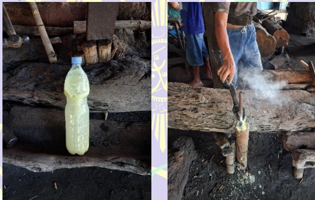
Gambar 2. 4 Proses Pendinginan dengan Air Belerang (Sumber: Dokumentasi Pribadi, 2026)
