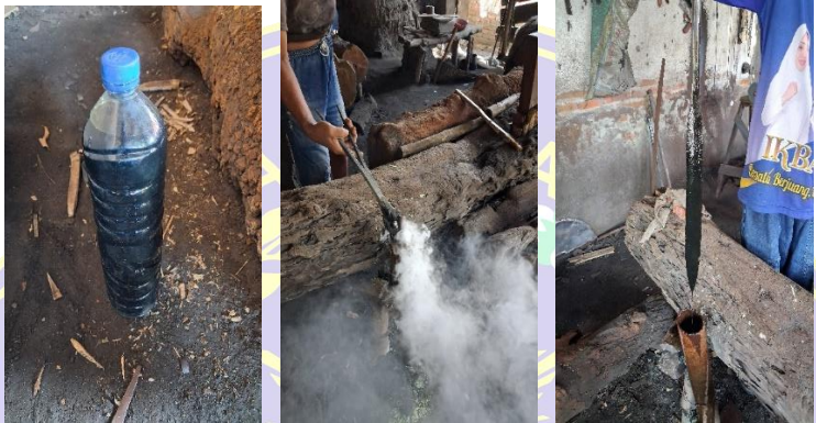
Gambar 2. 5 Proses Pendinginan dengan Oli Bekas (Sumber: Dokumentasi Pribadi, 2026)
