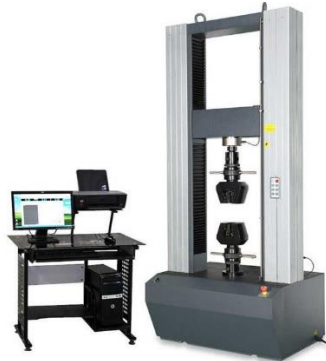
Gambar 2. 3 Mesin Uji Tarik (Universal Testing Machine) (Sumber: Dokumentasi Lab Teknik Mesin UMSurabaya, 2026)
