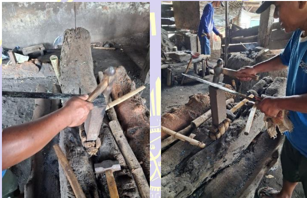
Gambar 2. 2 Proses Penempaan Keris (Sumber: Dokumentasi Pribadi, 2026)
