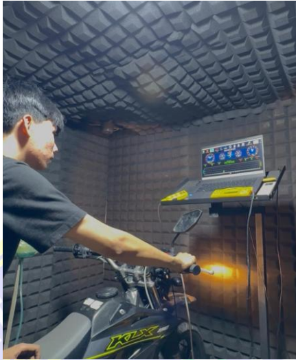
Gambar 3.11 proses pengujian konsumsi bahan bakar (Sumber : Foto Pribadi)
