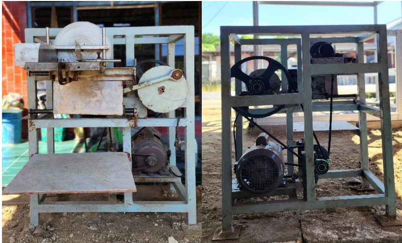
Gambar 3.2. Mesin Pemotong Tempe Tampak Depan & Belakang
