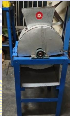
Gambar 2. 2. Mesin Pengupas Kulit Kacang Sumber : Dokumentasi Pribadi
