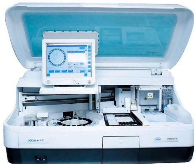
Gambar 2. 5 Alat Cobas e-411 Untuk Pemeriksaan HBsAg Metode ECLIA Sumber: https://diagnostics.roche.com/se/sv/products/instruments/cobas-e-411-ins-502.html
