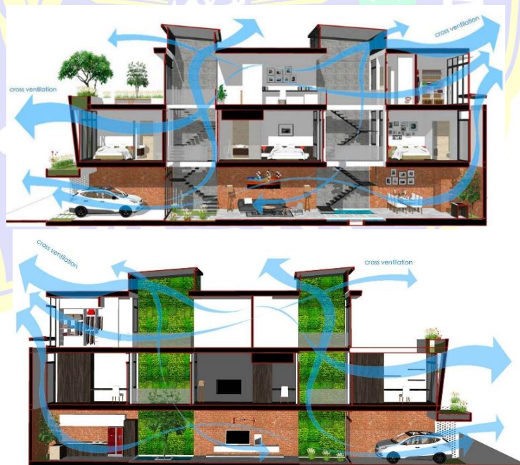
Gambar 2. 29 Alur sirkulasi udara didalam bangunan Sumber : https://share.google/images/pL5tly8ZOx9eT4lV , (2022)
