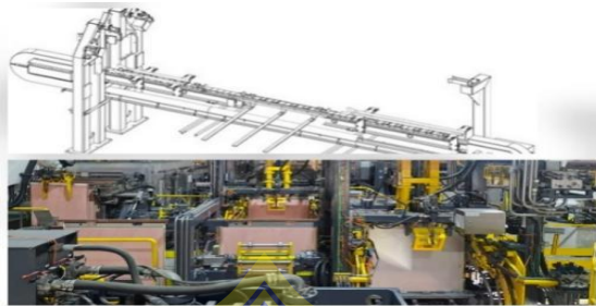
Gambar 2.3 Transverse Conveyor 1 dan Transverse Conveyor 2
