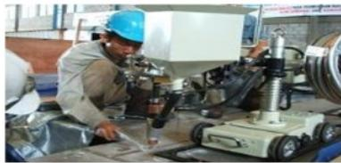
Gambar 6 Pengelasan DSS dengan SAW
