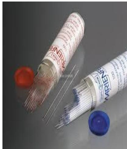
**Gambar 2.1 Pipet mikrohematokrit**
