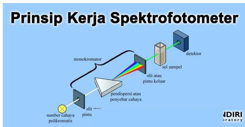
**Gambar 11.5 Prinsip Kerja Spektrofotometer**
