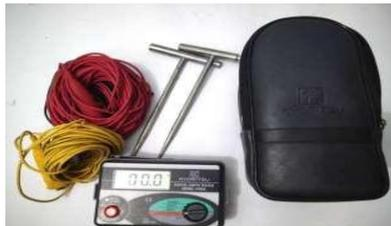
Gambar 2. 14 Earth Tester Kiyoritsu [1]
