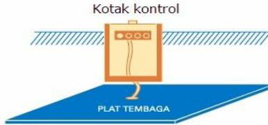
Gambar 2. 9 Elektroda Plat [12]
