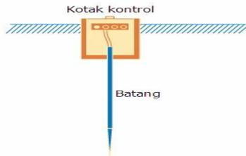
Gambar 2. 10 Elektroda Batang [12]
