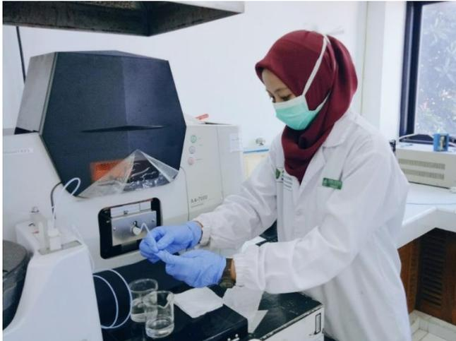
**Gambar 2.9 Spektrofotometer serapan atom (AAS)**
