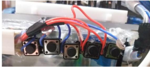
Gambar 4.4 set alarm untuk pakan menggunakan button
