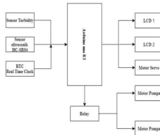
Gambar 3.1. Blok Diagram Sistem
